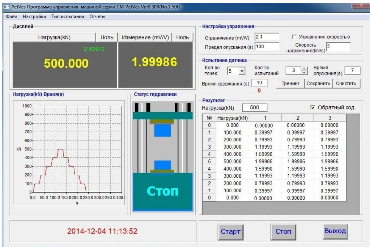
Основной интерфейс программного обеспечения состоит из отображаемых в реальном времени значений образцового и испытываемого датчиков, графиков происходящих процессов, состояние поршня, установка параметров управления, параметров испытания, результатов измерений и функциональных клавиш.
